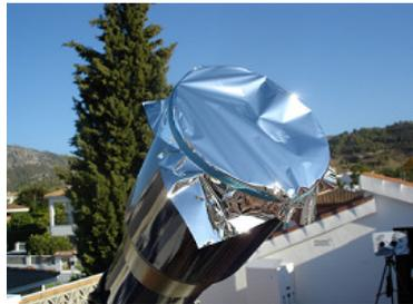
*Filtro de Sol tipo Mylar sobre objetivo del telescopio. Se trata de un filtro seguro que mantiene “frío” el telescopio.*
