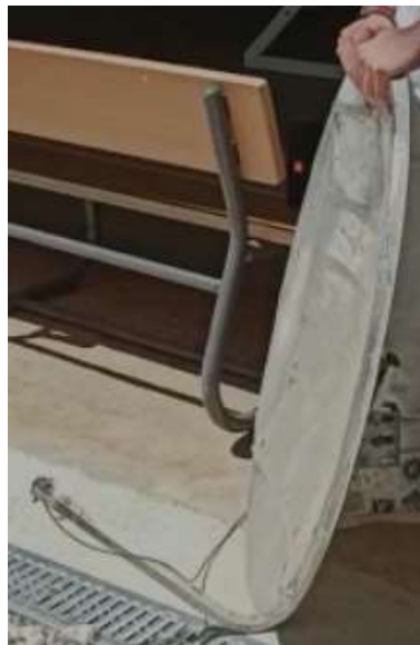
Imagen 7: Antena parabólica con el inductor. Pinchar en la imagen para ver video Otro video explicando el proceso. Aqui
